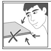
Während der Verlegung die Elemente auf Materialfehler überprüfen. Elemente mit sichtbaren Materialfehlern dürfen nicht verlegt werden.
