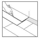
Heizköper (oder aufsteigende Bauelemente in der Fläche): Addieren Sie zum Durchmesser des aufsteigenden Elements ca. 10 mm und schneiden Sie das Element entsprechend zu. Achten Sie hier darauf, dass eine dauerhafte Verbindung zum Unterboden entsteht.
