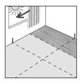
Ziehen Sie bei der weiteren Verlegung abschnittsweise den Klebstoff nach Herstellerangaben vor und fügen Sie anschließend die nächsten Elemente exakt zusammen, indem Sie die Elemente mit leichtem Druck in das Kleberbett legen. Wichtig ist es, den Bodenbelag fugendicht und spannungsfrei zu verlegen. Die Teilflächen sind unmittelbar vor der weiteren Verlegung mit einer geeigneten Handwalze oder einem Korkanreibebrett anzudrücken.
