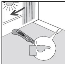
Halten Sie bereits bei der ersten Verlegereihe und anschließend zu allen weiteren aufsteigenden Bauelementen (Wände, Säulen, Heizungsrohre etc.) mindestens 10 mm Abstand. Dies kann durch Abstandskeile bewerkstelligt werden. Nichtbeachtung führt zu einem eingespannten Zustand der schwimmenden Konstruktion und führt zu Aufwölbungen im Bodenbelag und in der Folge ggf. zur Zerstörung der Click-Verbindung.
