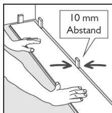
Fügen Sie anschließend das nächste Element mit Hilfe eines geeigneten Schlagklotzes vorsichtig an der Stirnseite ein. Keine Gewalt oder große Kräfteinwirkung anwenden.
