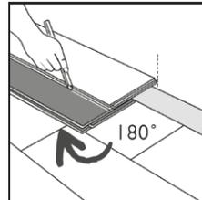
Heizkörper (oder aufsteigende Bauelemente in der Fläche): Addieren Sie zum Durchmesser des aufsteigenden Elements ca. 20mm und schneiden Sie das Element entsprechend zu. Getrennte Elemente kleben Sie ggf. mit geeignetem Klebstoff wieder zusammen. Achten Sie auch hier darauf, dass keine dauerhafte Verbindung zum Unterboden entsteht.
