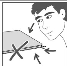
Während der Verlegung die Elemente aus mindestens drei oder mehr Paketen gleicher Charge mischen und auf Materialfehler überprüfen. Elemente mit sichtbaren Materialfehlern dürfen nicht verlegt werden.
