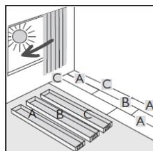
Beginnen Sie mit der Verlegung gemäß Verlegeplan in der linken Ecke der längsten Raumwand. Die Click-Verbindung an der Stirnseite und der Längsseite zu der angrenzenden Wand ist abzuschneiden. Dies gilt auch bei folgenden Elementen, die unmittelbar an Wände grenzen.
