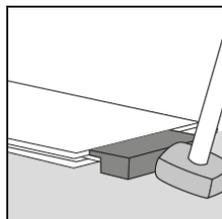
Das Reststück der letzten Elemente wird, sofern es mindestens 30cm lang ist, als Anfangselement der zweiten Reihe eingesetzt.
